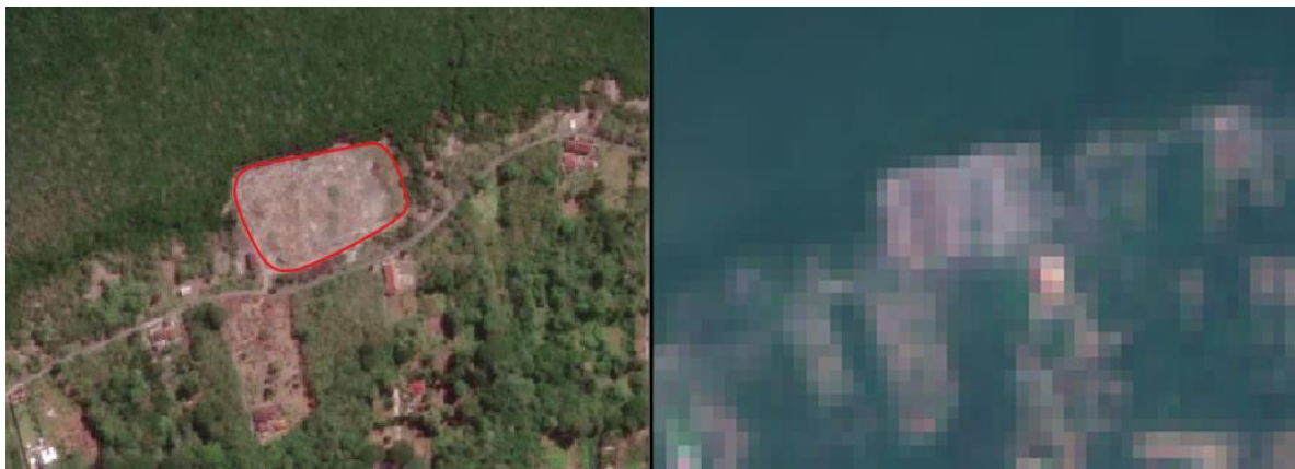
Hình 2. So sánh dữ liệu ảnh có độ phân giải cao với biên màu đỏ (hình bên trái) và vị trí tương ứng trong dữ liệu Sentinel-2 (hình bên phải).
