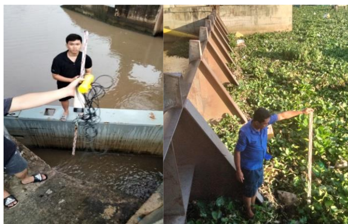
Hình 3. Dụng cụ đo đạc chiều sâu lớp bùn tại cửa cống.
